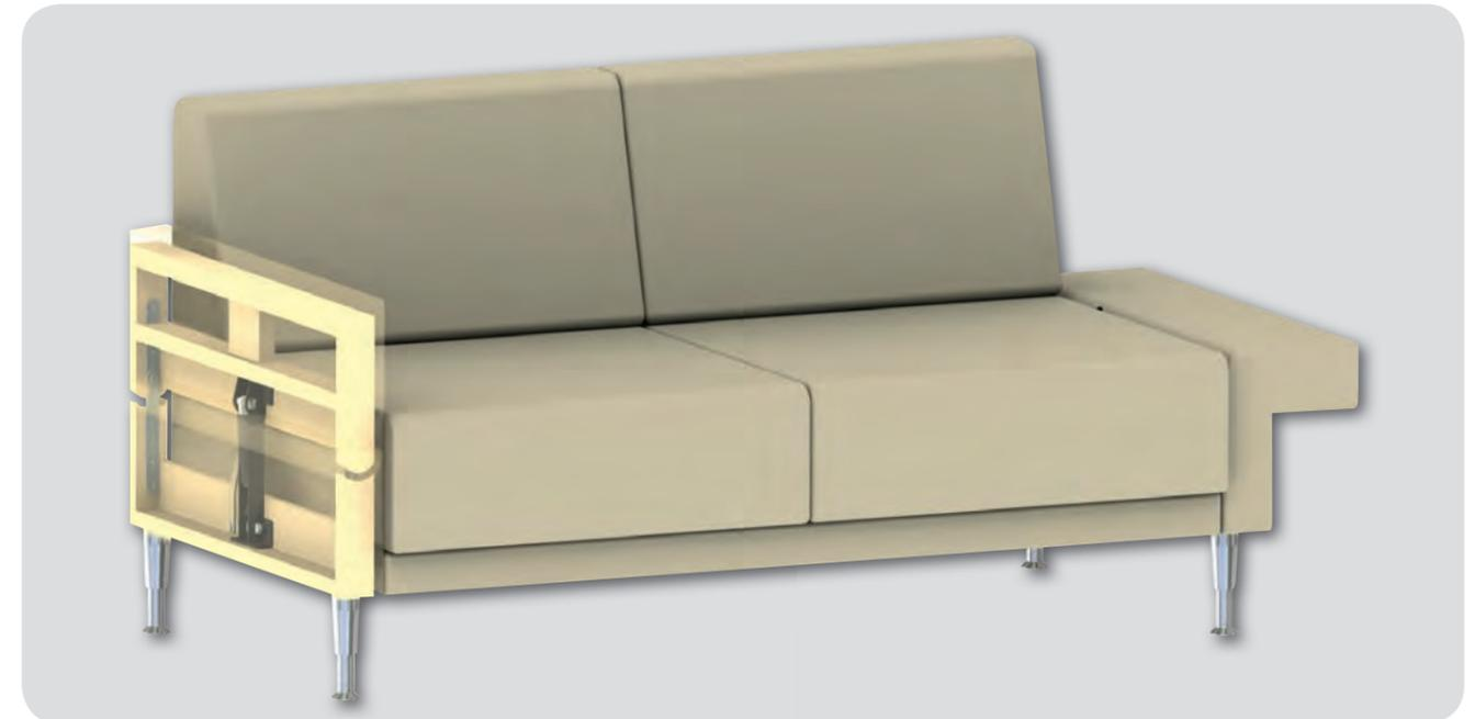
Dieser Sofa-Armlehnenbeschlag verzichtet erstmalig vollständig auf die üblichen und technisch oft anfälligen Rastgelenke und beugt damit etwaigen Reklamationen vor. Die Gasdruckfeder-geführte Zentraleinheit ist besonders robust und erlaubt eine hohe Belastung in jeder Position. Der Beschlag zeichnet sich insbesondere durch die absolut stufenlose Verstellung und vielfältige Einbaumöglichkeit in sehr schlanken Armlehnen aus.
